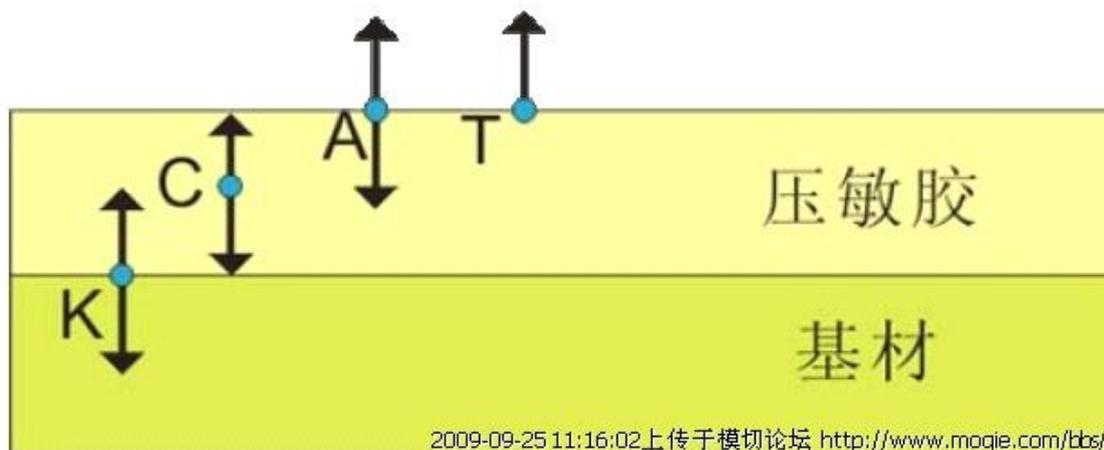
初粘力亦称快粘力，是指当压敏胶粘带的压敏胶面与被粘物表面以很轻的压力接触后、立即快速分离所表现出来的抵抗分离的能力。一般即所谓用手指轻轻接触压敏胶面并立即移开时所显示出来的手感粘力。这是压敏胶粘带所特有的一种实用粘合性能。
